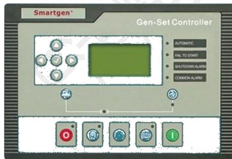
自动化并机机组控制屏通过对发电机组各种参数的采集以及机组之间的通讯，根据用户设置的值进行自动高速计算，对机组的电压、频率、相位角自动进行调整并达到同步、自动合闸并机。然后对机组及机组之间进行有功及无功功率管理和协调整套系统内机组加减控制。具有全自动全过程电脑数字控制，机组具有自动起动，自动同步并机、自动负载分配、并机自动装卸载、逆功保护、机组各种故障保护、负载过载保护、带有柔性加减负荷功能，减少对机组的冲击，系统可以同时管理10台发电机组并网。
