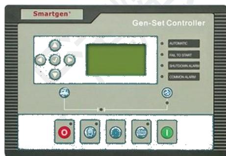
自动化并机机组控制屏通过对发电机组各种参数的采集以及机组之间的通讯，根据用户设置的值进行自动高速计算，对机组的电压、频率、相位角自动进行调整并达到同步、自动合闸并机。然后对机组及机组之间进行有功及无功功率管理和协调整套系统内机组加减控制。具有全自动全过程电脑数字控制，机组具有自动启动，自动同步并机、自动负载分配、并机自动装卸载、逆功保护、机组各种故障保护、负载过载保护、带有柔性加减负荷功能，减少对机组的冲击，系统可以同时管理10台发电机组并网。
