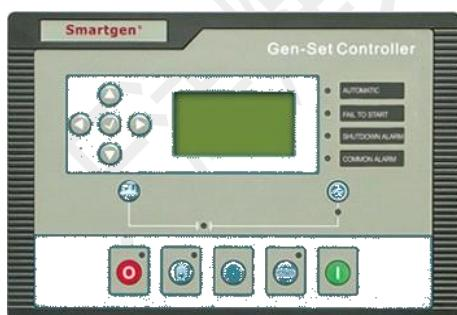
自动化并机机组控制屏通过对发电机组各种参数的采集以及机组之间的通讯，根据用户设置的值进行自动高速计算，对机组的电压、频率、相位角自动进行调整并达到同步、自动合闸并机。然后对机组及机组之间进行有功及无功功率管理和协调调整套系统内机组加减控制。具有全自动全过程电脑数字控制，机组具有自动起动，自动同步并机、自动负载分配、并机自动装卸载、逆功保护、机组各种故障保护、负载过载保护、带有柔性加减负荷功能，减少对机组的冲击，系统可以同时管理10台发电机组并网。
