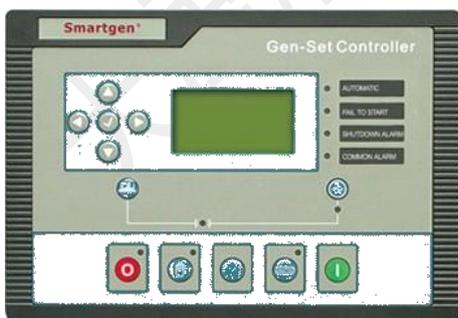
自动化并机机组控制屏通过对发电机组各种参数的采集以及机组之间的通讯，根据用户设置的值进行自动高速计算，对机组的电压、频率、相位角自动进行调整并达到同步、自动合闸并机。然后对机组及机组之间进行有功及无功功率管理和协调整套系统内机组加减控制。具有全自动全过程电脑数字控制，机组具有自动起动，自动同步并机、自动负载分配、并机自动装卸载、逆功保护、机组各种故障保护、负载过载保护、带有柔性加减负荷功能，减少对机组的冲击，系统可以同时管理10台发电机组并网。
