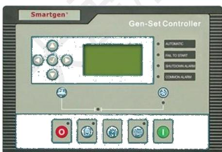
自动化并机机组控制屏通过对发电机组各种参数的采集以及机组之间的通讯，根据用户设置的值进行自动高速计算，对机组的电压、频率、相位角自动进行调整并达到同步、自动合闸并机。然后对机组及机组之间进行有功及无功功率管理和协调调整套系统内机组加减控制。具有全自动全过程电脑数字控制，机组具有自动起动，自动同步并机、自动负载分配、并机自动装卸载、逆功保护、机组各种故障保护、负载过载保护、带有柔性加减负荷功能，减少对机组的冲击，系统可以同时管理10台发电机组并网。
